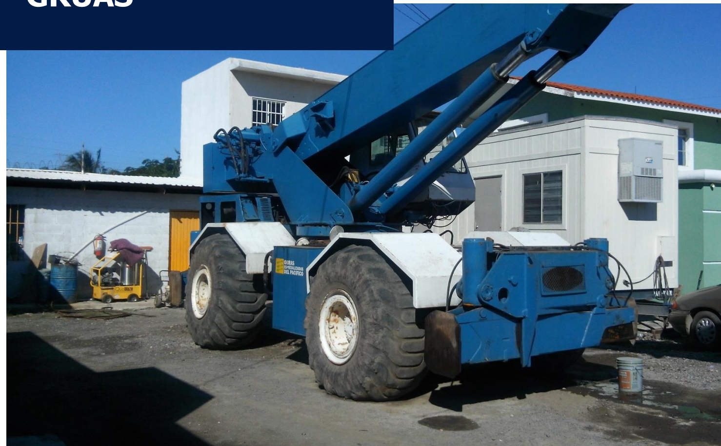
GRUA GRUA NEUMATICA TODO TERRENO MARCA P&H MODELO OMEGA 60 CAPACIDAD 60 TON SERIE 45273
