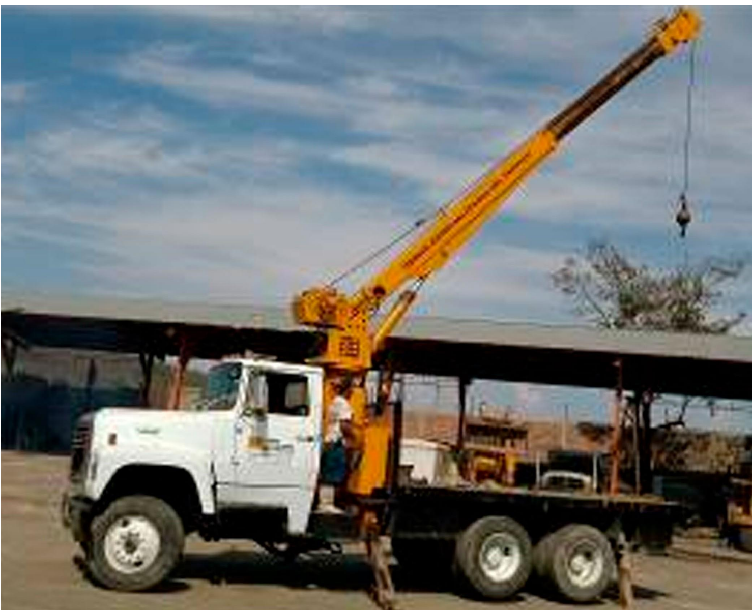
GRUA CAMION GRUA L800 MARCA FORD MODELO 1989 CAPACIDAD 10 TON SERIE 1FDYU82A6KVA47093
