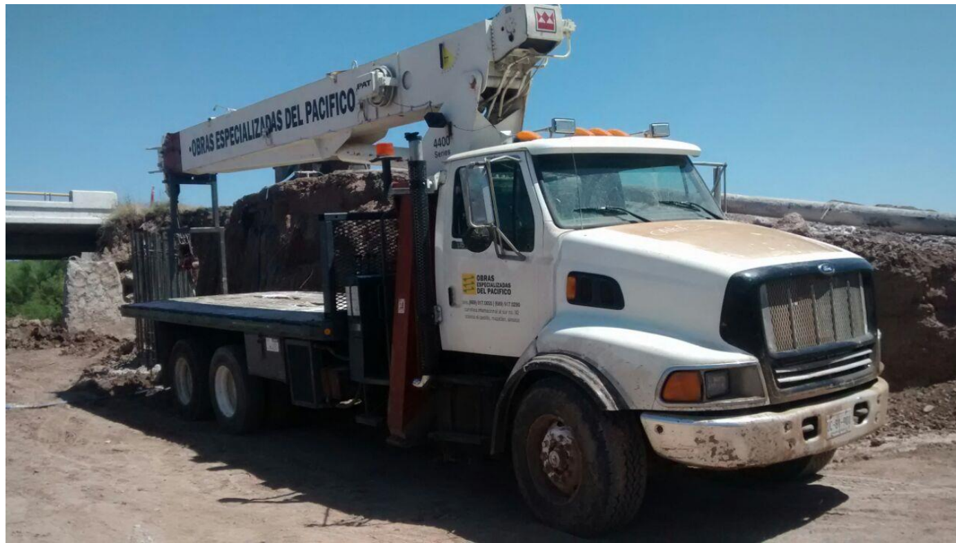
GRUA CAMION GRUA TEREX6X4 MARCA FORD MODELO 1998 CAPACIDAD 22 TON SERIE 1FDZS96P5WVA13537
