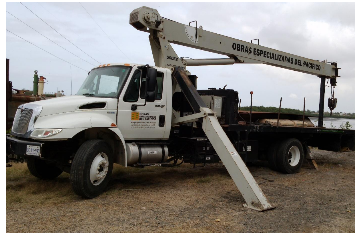
GRUA CAMION GRUA 4300 MARCA INTERNATIONAL MODELO 2012 CAPACIDAD 18 TON SERIE 3HAMMAAR3CL625987
