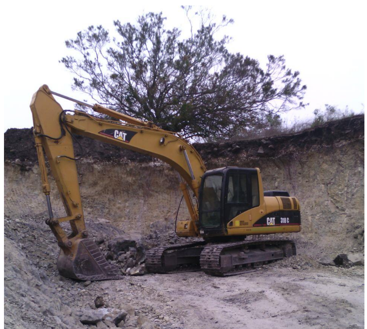
EXCAVADORA EXCAVADORA HIDARULICA MARCA CARTEPILLAR 318C MODELO 2005
